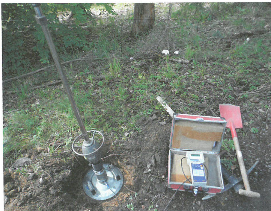
Foto 2 – rázová zatěžovací zkouška na podloží LC, V-1 (0,400 km, L)
