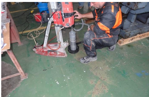
Obr. 5. Vývrt pro zjištění skladby podlahy.
