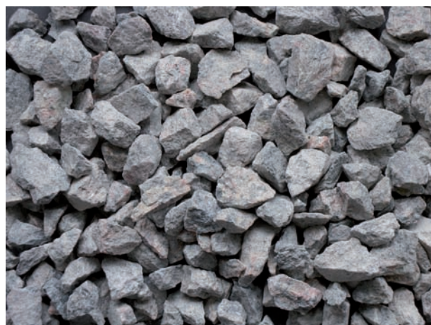
vzorek kameniva frakce 4/8 nevypraný
