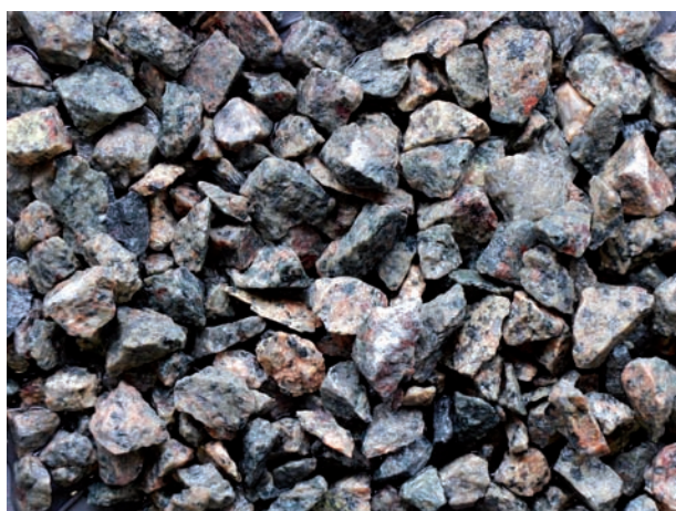
vzorek kameniva frakce 4/8 nevypraný, namočený
