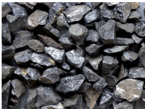
vzorek kameniva frakce 16/32 vypraný, namočený
