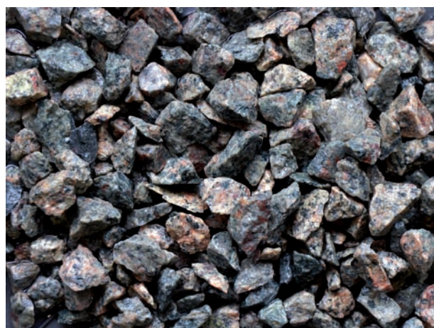
vzorek kameniva frakce 4/8 10 min. po namočení
