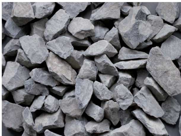
vzorek kameniva frakce 16/32 nevypraný
