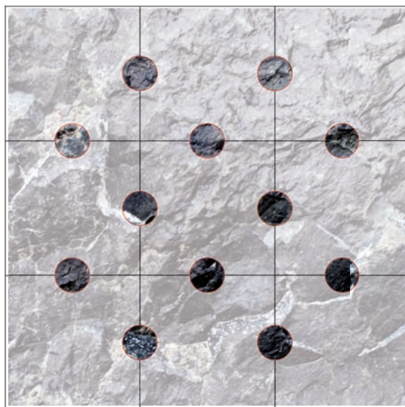
rastr při měření kamene
