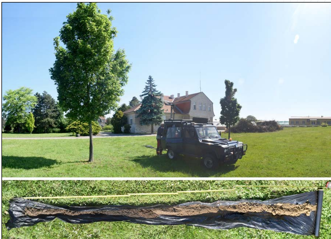
situování a hmotná dokumentace vrtu V-1
