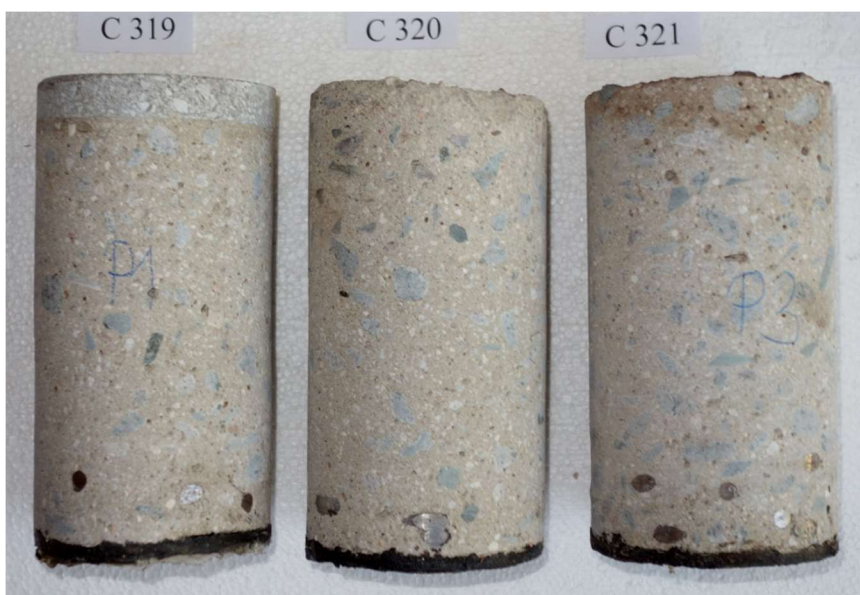
Obr. 1.: Vývrty z betonu po dodání do laboratoře
