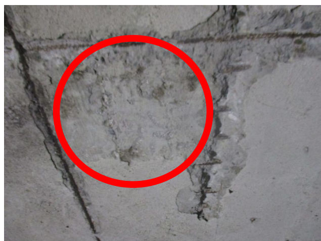
foto/6/ Pohled na zkoušenou plochu - ověření pevnosti betonu nedestruktivní zkouškou
