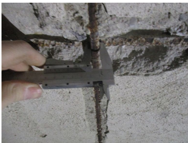
foto/7/ Pohled na průměr podélné výztuže – 10 mm
