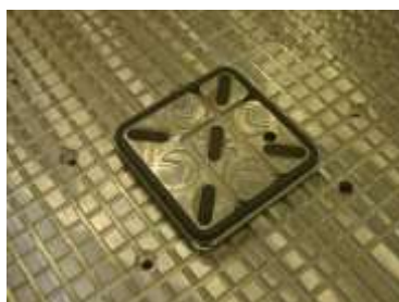
Multifunkční hliníkový pracovní stůl s integrovaným systémem podtlaku
