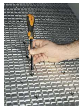
Multifunkční hliníkový pracovní stůl s integrovaným systémem podtlaku
